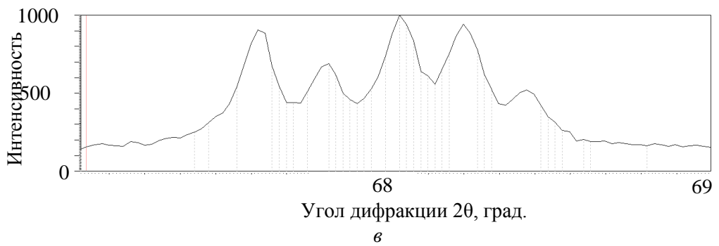
Рис. 4. Дифрактограммы образцов кварца в области 67^{\circ} – 69^{\circ} : a – кварцевый песчаник Флёровской площади (образец № 1); б – кварцевый песчаник Флёровской площади (образец № 5); в – морион
