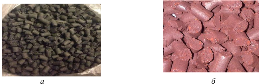
Рис. 1. Гранулированные шихты: a – Ti+C; б – Fe 2 O 3 +Al
