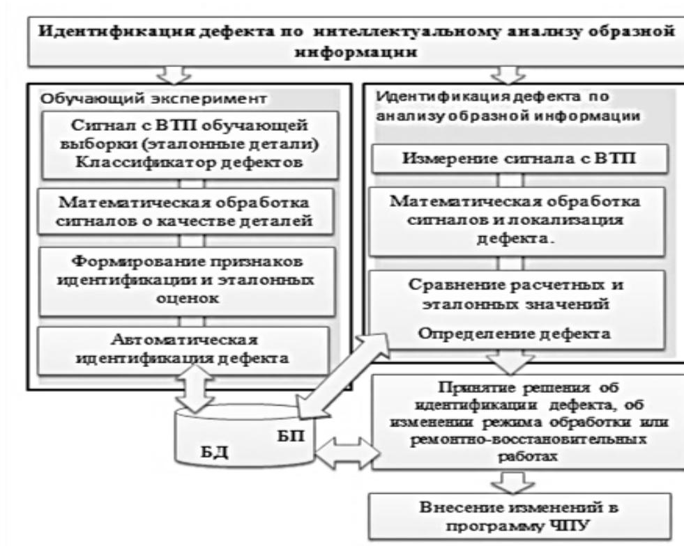
Рис. 2. Алгоритмизация идентификации дефектов шлифования деталей по интеллектуальному анализу образной информации
