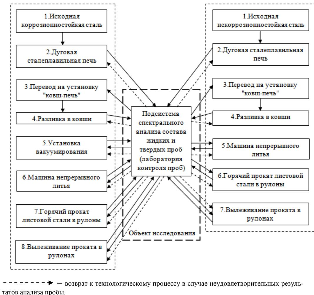
Рис. 1. Иерархическая структура технологического процесса литейно-прокатного комплекса
