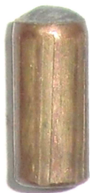
Рис. 7. Пуля со свинцовым сердечником 7.62 мм карабина «Барс», уловленная в тормозной системе
