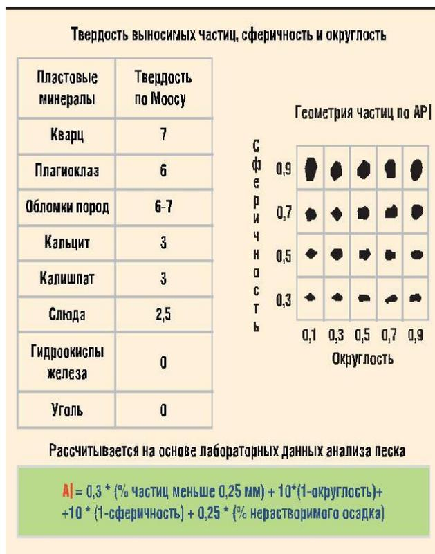
Рис. 1. Диаграмма для визуального определения округлости частиц
