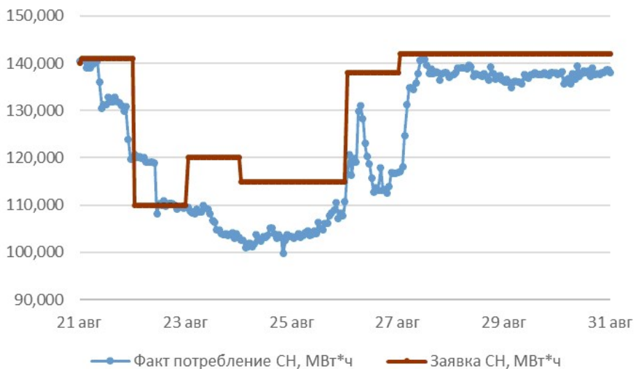
Рис. 2. Часть графика, отражающего фактические и прогнозные значения электропотребления системой СН АЭС за август 2021 года
