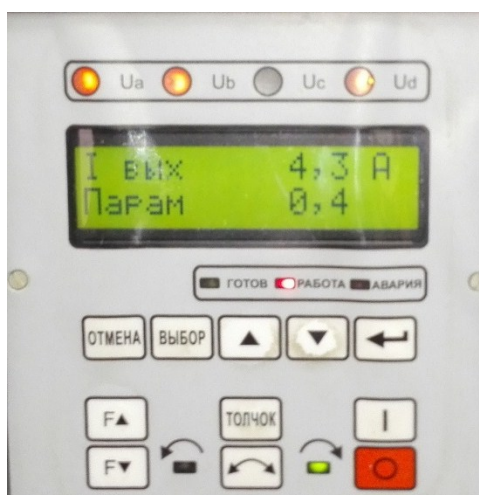
Рис. 3. Дисплей частотного преобразователя «Омега» с информацией о токе статора
