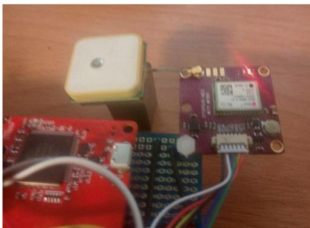
Рис. 7. Подключенный GPS-модуль
