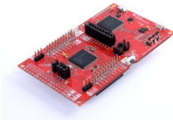
Рис. 4. Микроконтроллер MSP432P401R
