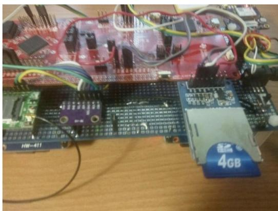
Рис. 8. Подключенные датчики и SD-карта
