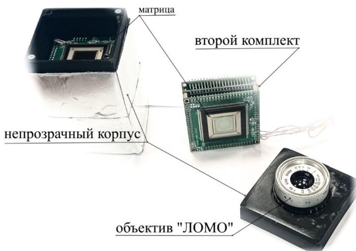
Рис. 8. Макет системы захвата изображения
