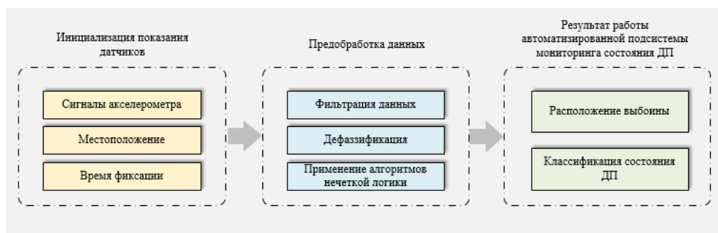
Рис. 6. Обобщенная схема метода мониторинга состояния дорожного покрытия
