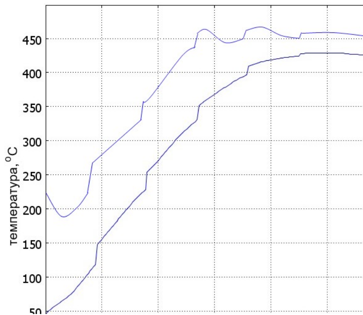
Рис. 2. Диаграммы температуры на поверхности (1) и оси (2) загрузки в момент времени 7000 с
