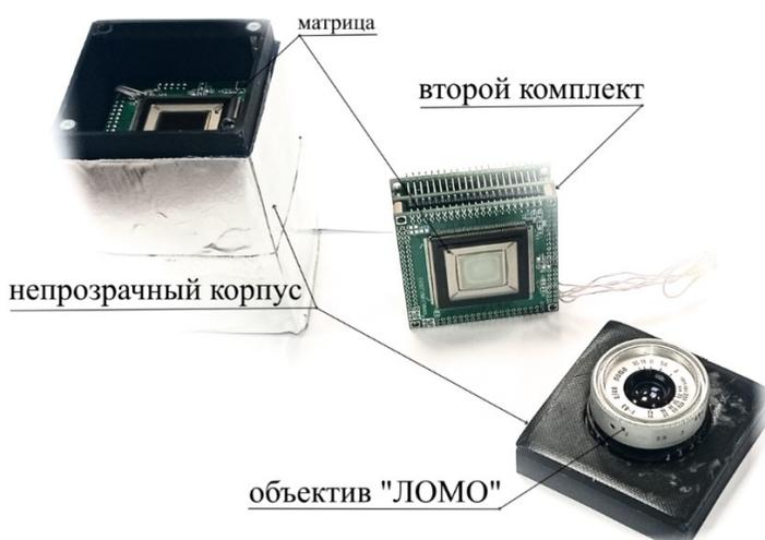
Рис. 8. Макет системы захвата изображения
