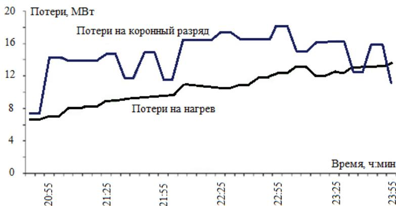
Рис. 1. Результаты измерения потерь мощности на корону и в проводах ВЛ 750 кВ Калининская АЭС – Владимирская, 04.01.2011
