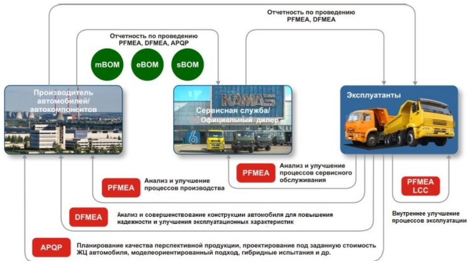
Рис. 2. Схема взаимодействия в рамках РССА при организации технического обслуживания роботизированных автомобилей
