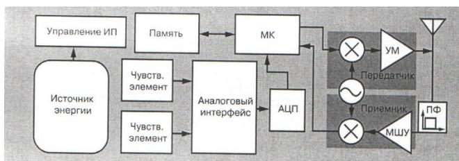
Рис.2. Блок-схема встроенных датчиков
