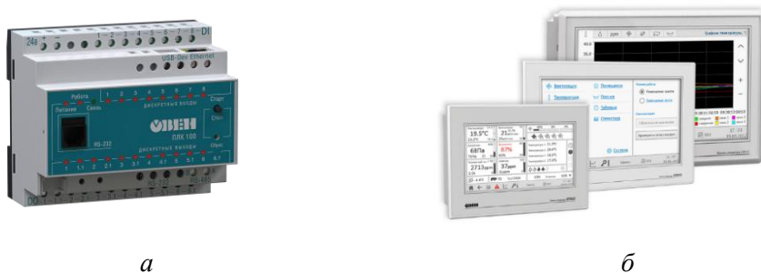
Рис. 11. Вид средств автоматизации компании ОВЕН: а – ПЛК150; б – панели оператора семейства ОВЕН СП37хх
