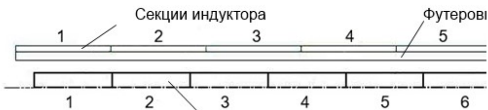
Рис. 1. Расположение заготовок и секций индуктора
