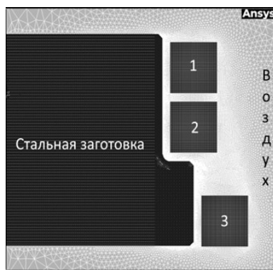
Рис. 2. Двумерная осесимметричная модель системы «индукционный нагреватель – стальная заготовка»: a – общий вид геометрии заготовки; б – параметры геометрии витков индуктора; в – наложенная конечно-элементная сетка в ППП ANSYS Mechanical APDL
