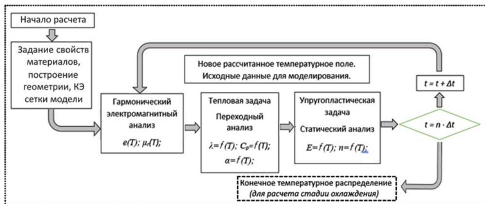
Рис. 1. Алгоритм моделирования стадии индукционного нагрева
