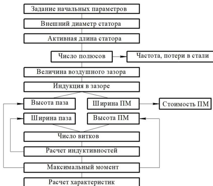
Рис. 2. Блок-схема алгоритма проектирования ТД по максимуму момента
