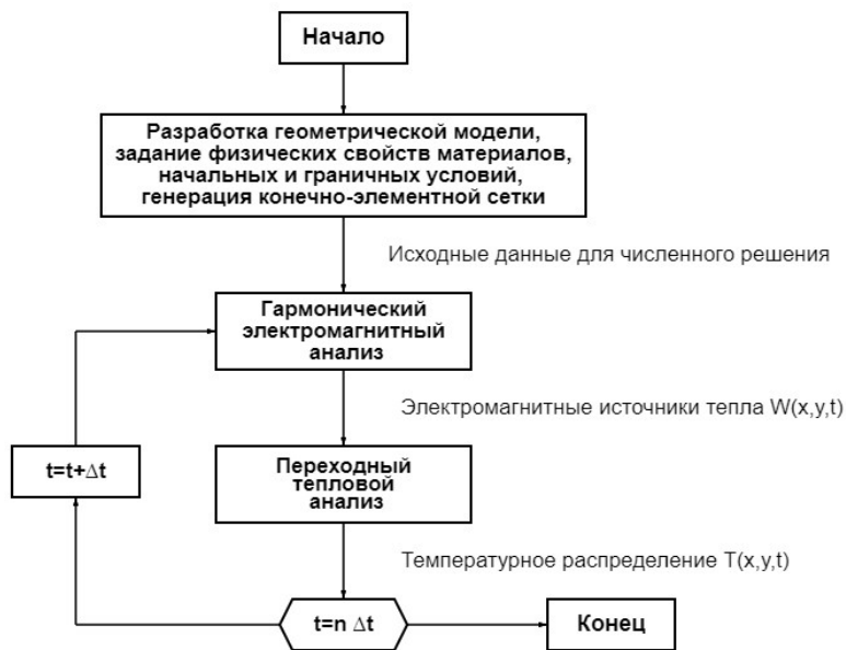
Рис. 3. Последовательность решения задачи численного моделирования процесса зонного индукционного нагрева
