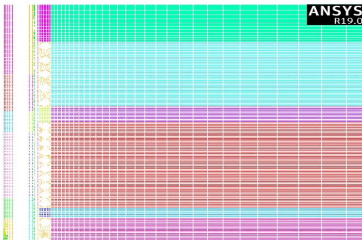
Рис. 10. Система «заготовка – индуктор» с наложенной конечно-элементной сеткой
