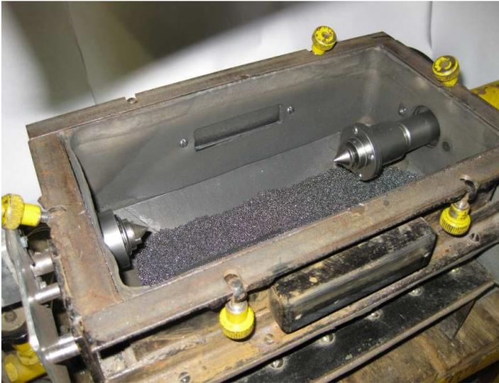
Рис. 2. Установка для пневмодробеструйной обработки без крышки (фото из [29, с. 51])
