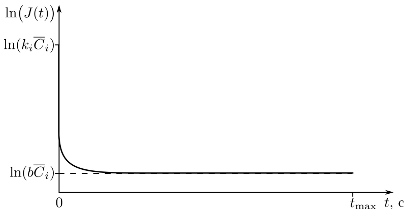
Рис. 2. Схематический график зависимости логарифма интенсивности испарения от времени для слоя бесконечной глубины
