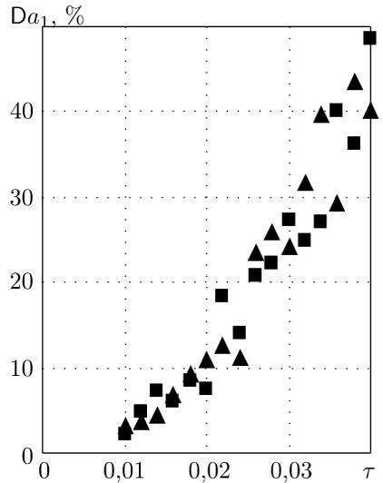
Рис. 7. Зависимость дисперсии оценки коэффициента  $a_1$  от периода дискретизации  $\tau$
