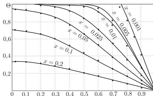
Рис. 2. Распределение температуры при ламинарном течении жидкости в круглой трубе: точки — точное решение [1]; сплошная линия — расчёт по формуле (26) (четвёртое приближение,  $l = 4$ )
