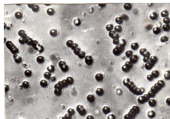
Рис. 1. Дислокационная структура плёнок \text{Mn}_{1,22}\text{Fe}_{1,78}\text{O}_4 толщиной 20 мкм ( \times 1500 )
