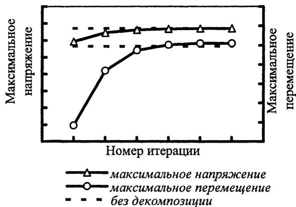
Р и с. 11. Зависимость максимальных перемещения и напряжения от числа итераций при декомпозиции элемента пространственной конструкции на 8 подконструкций ( $\nu_\alpha = 8$ )
