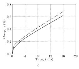
Рис. 3. Экспериментальные (сплошные линии) и расчетные (штриховые линии) кривые ползучести образцов (кривые угла закручивания) из стали  $3XB4C\Phi$  (a) и сплава 9M437B (b) при кручении:  $a-\tau=144.5$  МПа,  $b-\tau=92.5$  МПа
