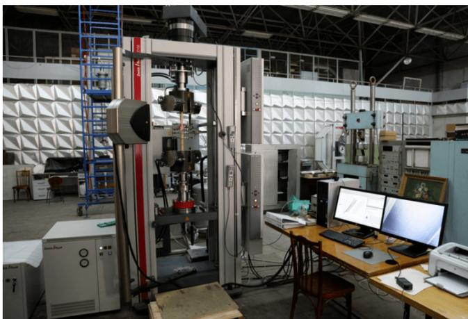
Рис. 2. Общий вид испытательной машины Z100 ZWICK-ROEL
