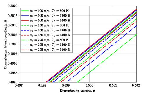
Рис. 3. Центральная часть профилей скорости при значительном приближении для различных значений  $T_0$  и  $u_1$
