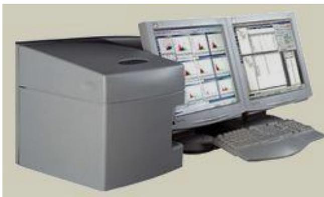
Рис. 2. Проточный цитофлюориметр
