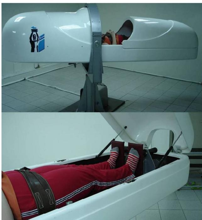
Рис. Стенд искусственной силы тяжести «Салют» (центрифуга короткого радиуса действия)
