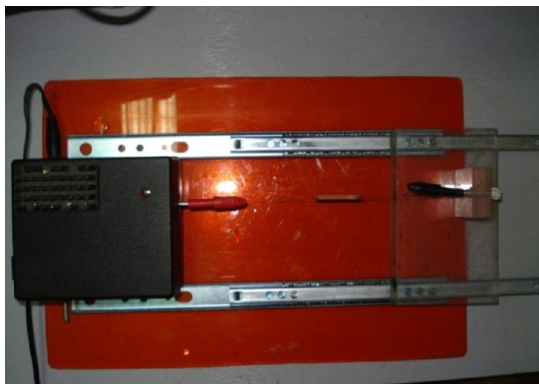
Рис. 6. Установка для равномерной просушки стента (вид сверху и сбоку)
