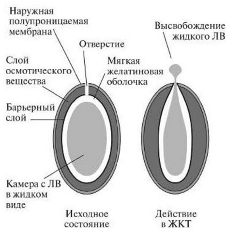
Рис. 5. Схема строения системы L-OROS Softcap
