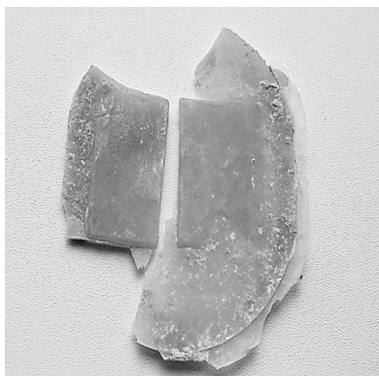
Рис. 5. Пластинки базисной пластмассы после полимеризации на образце с гиперпластификатором
