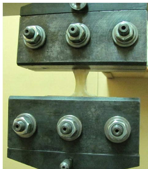
Рис. 3. Аллосухожилие длинной малоберцовой мышцы, фиксированное в держателях разрывной машины
