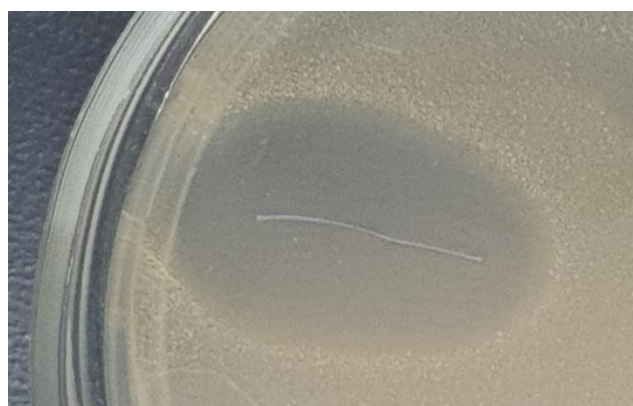
Рис. 1. Задержка зоны роста тест-микроорганизмов вокруг образца шовного материала
