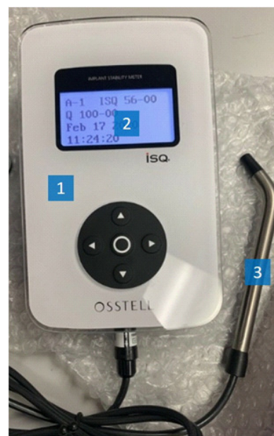
Рис. 2. Резонансно-частотный анализатор Osstell mentor
