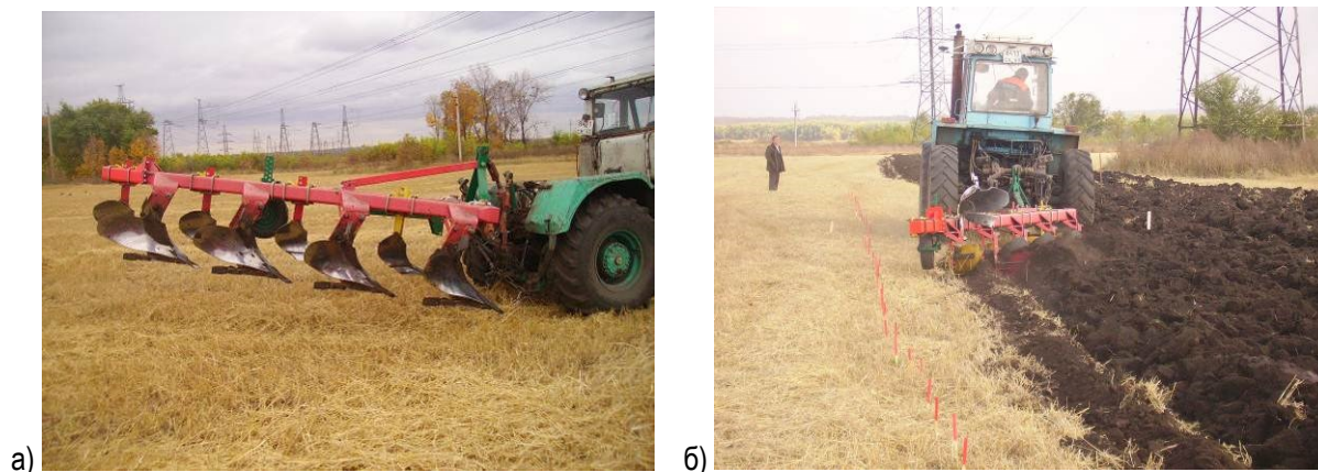
Рис. 1. Комбинированный плуг на полевых исследованиях: а – общий вид комбинированного плуга; б – комбинированный плуг в работе
