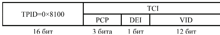
Рисунок 3. Формат заголовка 802.1Q
