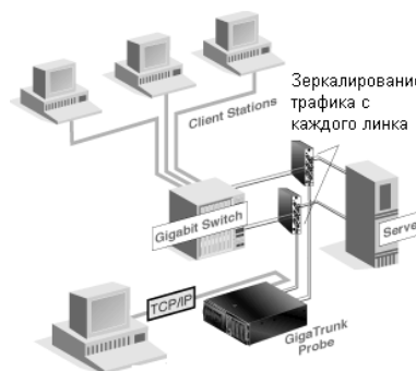
Рис. 1. Пример подключения зонда «GigaTrunk Probe Appliance» фирмы Network Instruments
