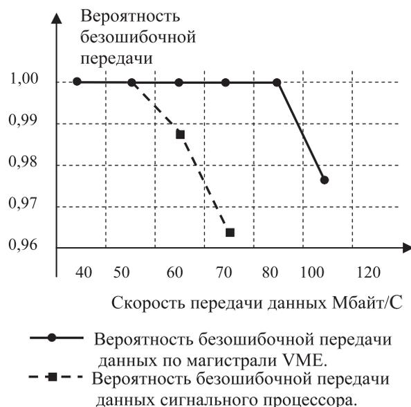
Рис. 4. Зависимости вероятности безошибочной передачи данных от скорости обмена интерфейсов устройств с контроллером
