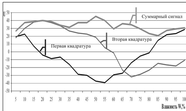
Рис. 5. Зависимость  $U_{\text{св}}$  от влажности при неравномерном намокании грунта
