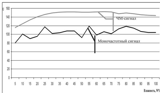
Рис. 6. Зависимости  $U_{\text{сред}}$  ЧМ-сигнала и  $U_{\text{св}}$  моночастотного сигнала от влажности при «равномерном» намокании грунта
