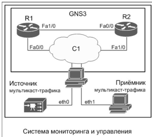
Рис. 5. Пример работы модели мониторинга IPTV
