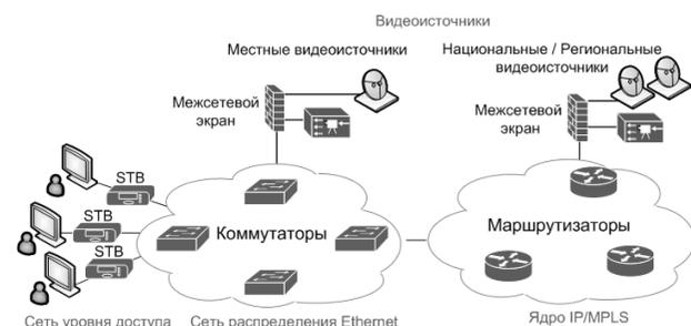
Рис. 1. Типовая схема сети IPTV
