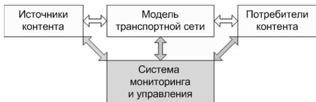
Рис. 2. Структурная схема модели мониторинга IPTV мультисервисной сети передачи данных
