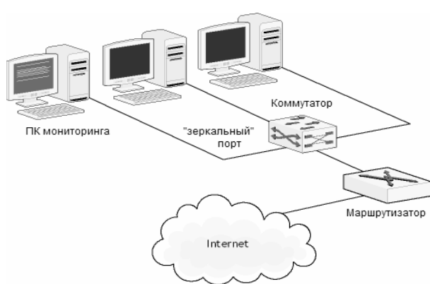
Рис. 3. Вариант 1: схема подключения с одним управляемым коммутатором
