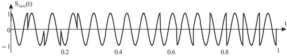
Рис. 1. Амплитудно-фазомодулированный сигнал, в случае модуляции последовательностью  $\Gamma = (1, 1, 1, 1, 1, i, -1, -i, 1, -1, 1, -1, 1, -i, -1, i)$
