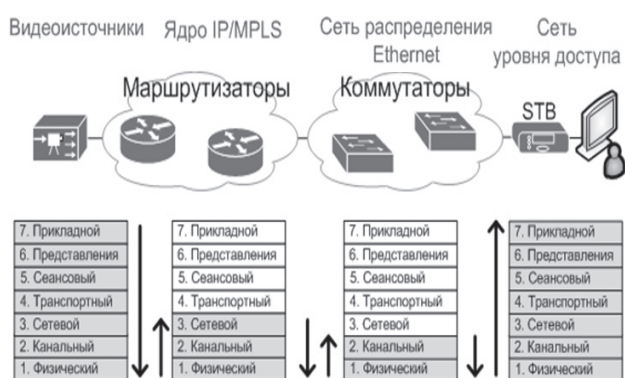
Рис. 10. Инкапсуляция видеопотока в сетях IP-телевидения
