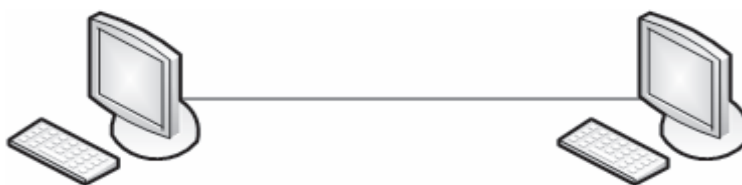
Рис. 2. Соединение двух компьютеров при помощи витой пары типа «cross»
