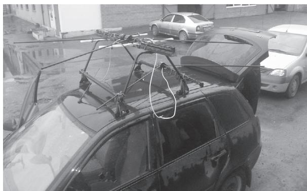
Рис. 2. АФУ МПРЛК, установленное на автомобиле
