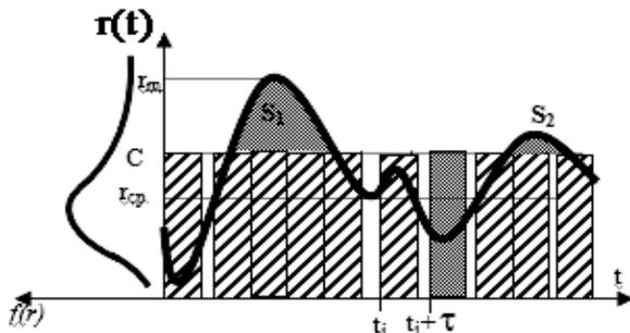
Рис. 1. Принцип преобразования битового потока в поток пакетов
