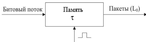
Рис. 2. Процесс преобразования битового потока в поток пакетов
