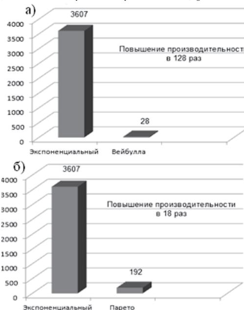
Рис. 3. Верхние оценки производительности при преобразовании в экспоненциальный закон законов: а) Вейбулла; б) Парето
